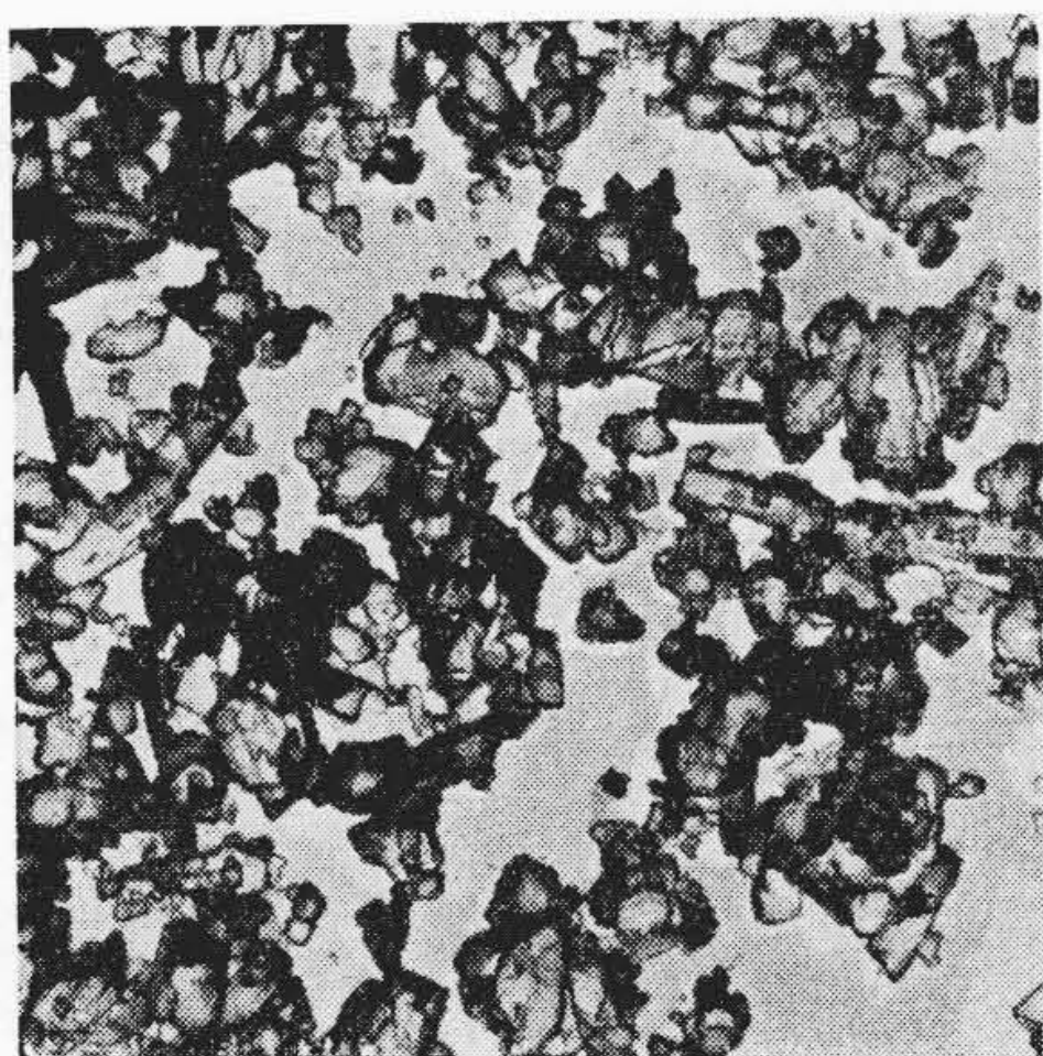
第12図 粉碎48時間 (=) ×6,000 針状炭酸塩電子顕微鏡写真 (C-replica)
