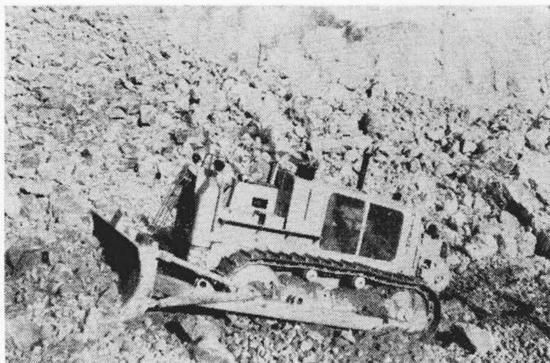
第5図 仙台火力発電所敷地用埋立骨材採集中のT14Aアングルドーザ
