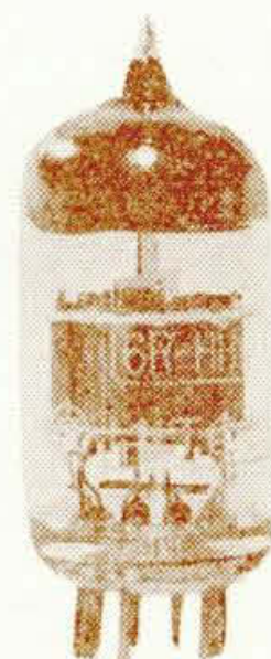
第 29 図 超高感度高周波 増幅管 6R-HH1
