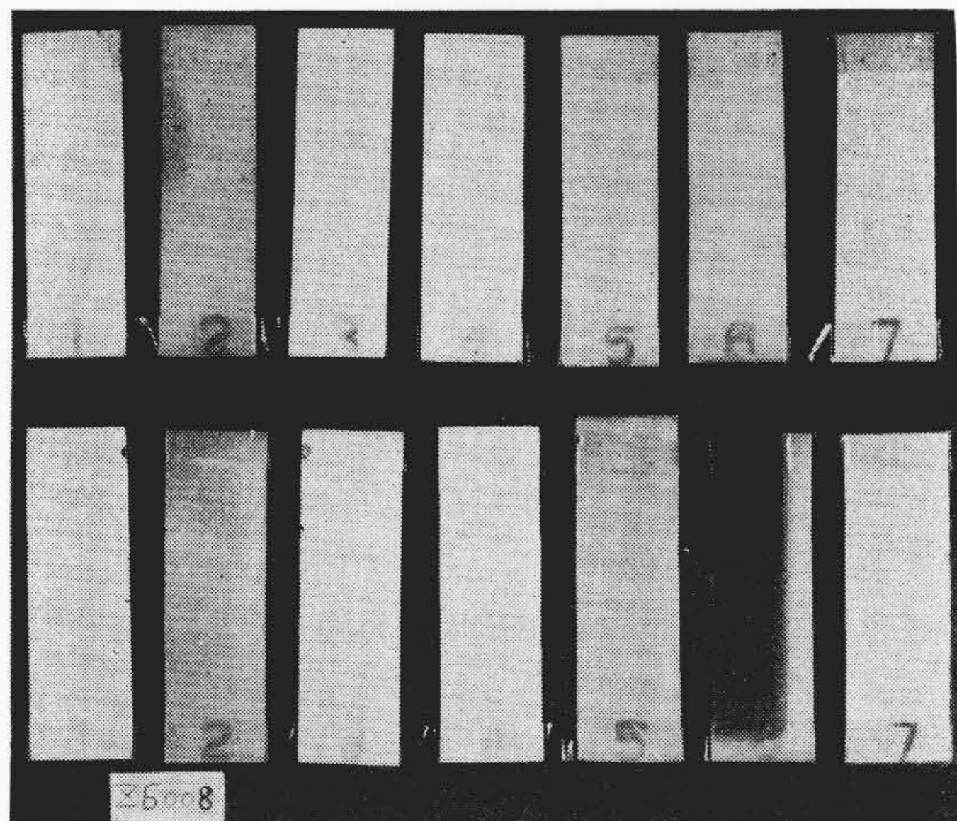
第7図 ルミパネルの耐酸, 耐アルカリ試験結果 (常温)
