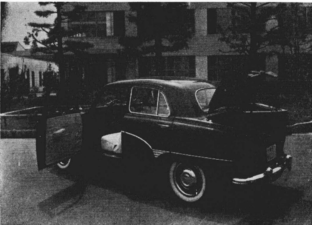
第4図 SEM-051形移動用無線電話装置装着状況
