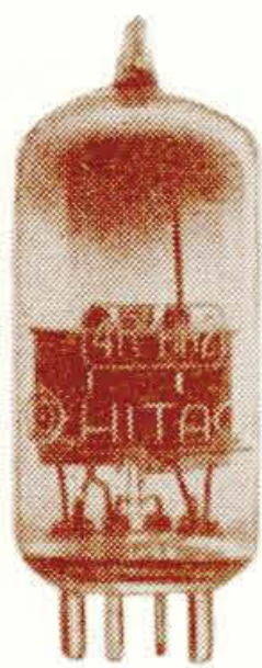
第10図 高感度テレビ チューナ用受信管 4R-HH2
