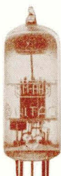
第11図 高感度テレビ チューナ用受信管 5M-HH3
