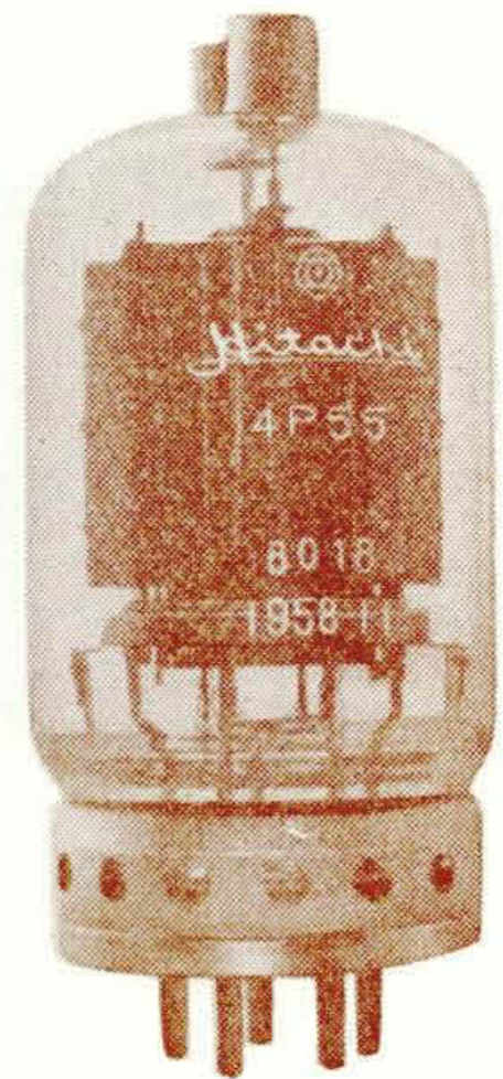
第8図 送信用自然空冷 5 極管 4P55
