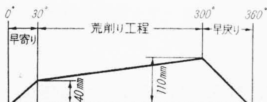
第5図 荒削りカム曲線展開図
