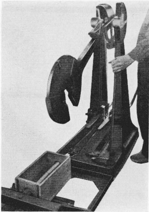
第 8 図 スプリングの脆性試験装置
