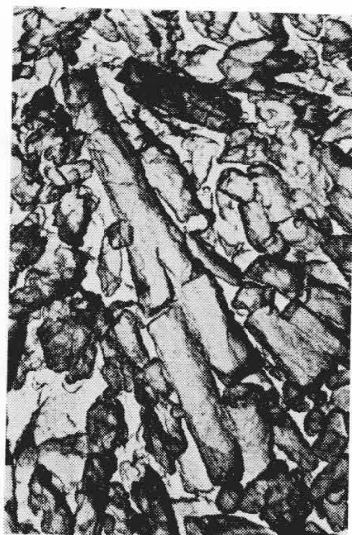
(b) 1,040°C, 10分 加熱後空气中 10分 放置 ( \times 10,000 )
