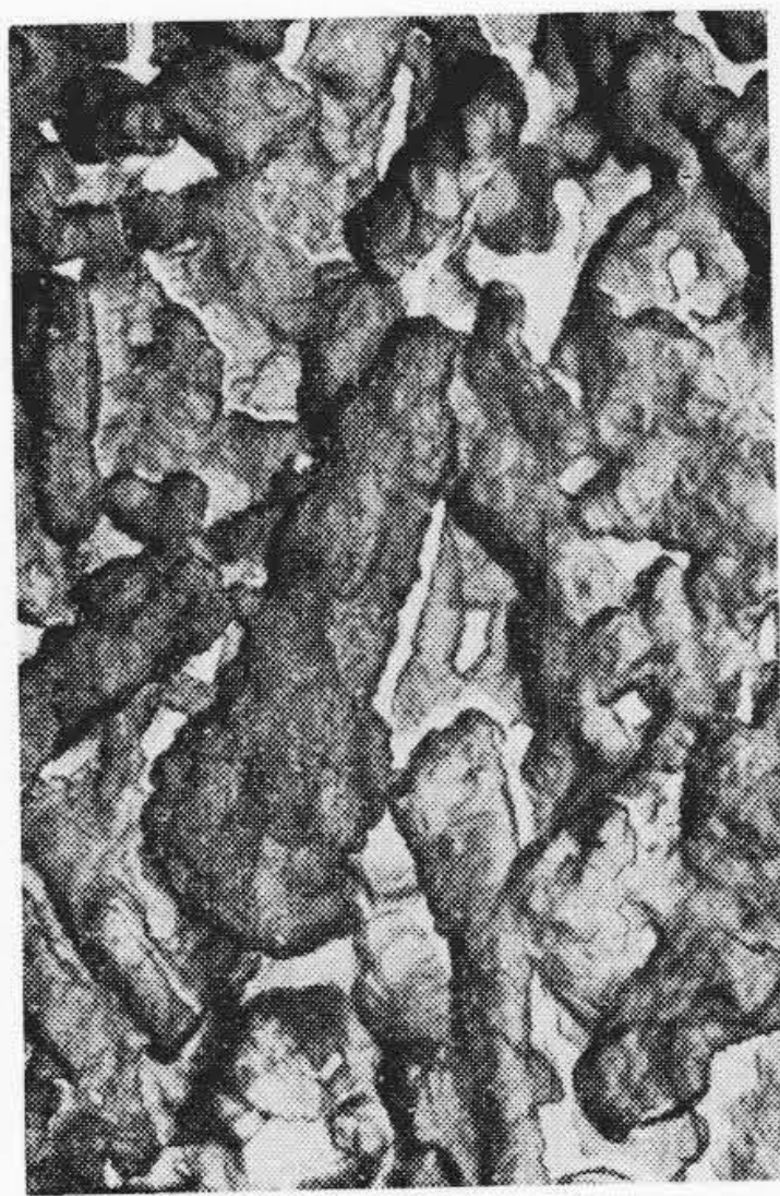
(b) 850°C, 5分 \rightarrow 970°C, 5分 \rightarrow 1,040°C, 5分 \rightarrow 空气中, 10分 \rightarrow 1,040°C, 10分 ( \times 10,000 )
