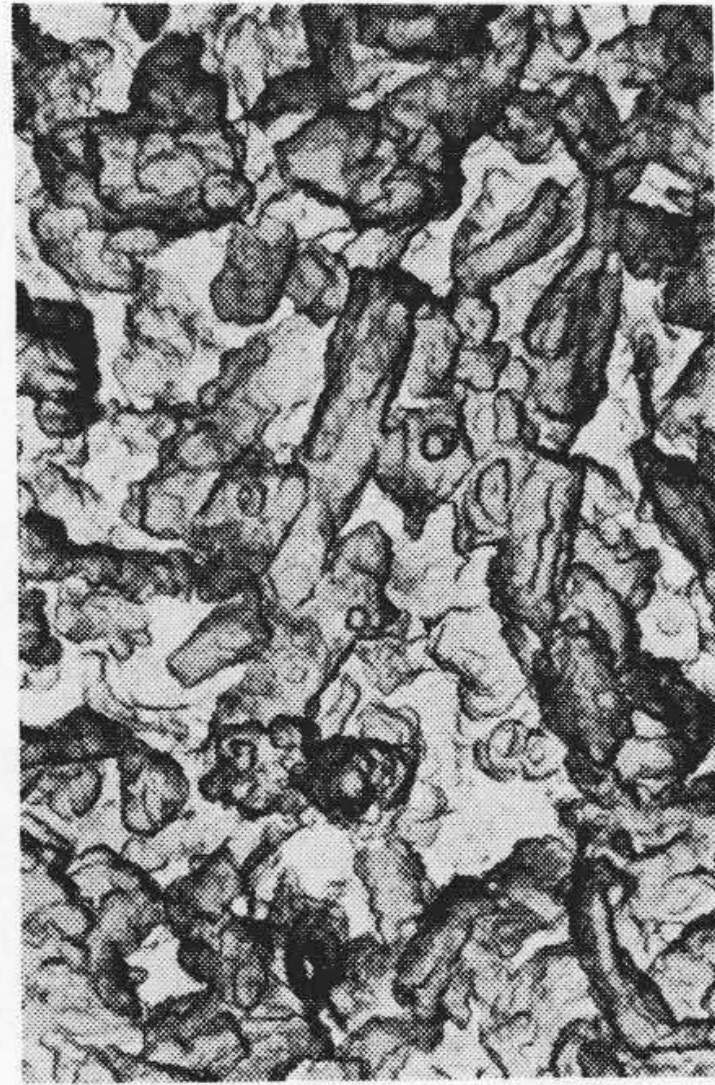
(b) 1,050°C, 10分 加熱後空气中 10' 放置 ( \times 10,000 )
