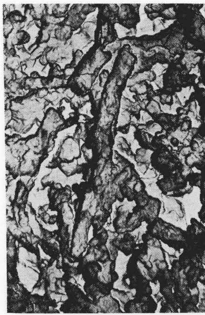
(b) 1,040°C, 10分 加熱後空气中 10分 放置 ( \times 10,000 )
