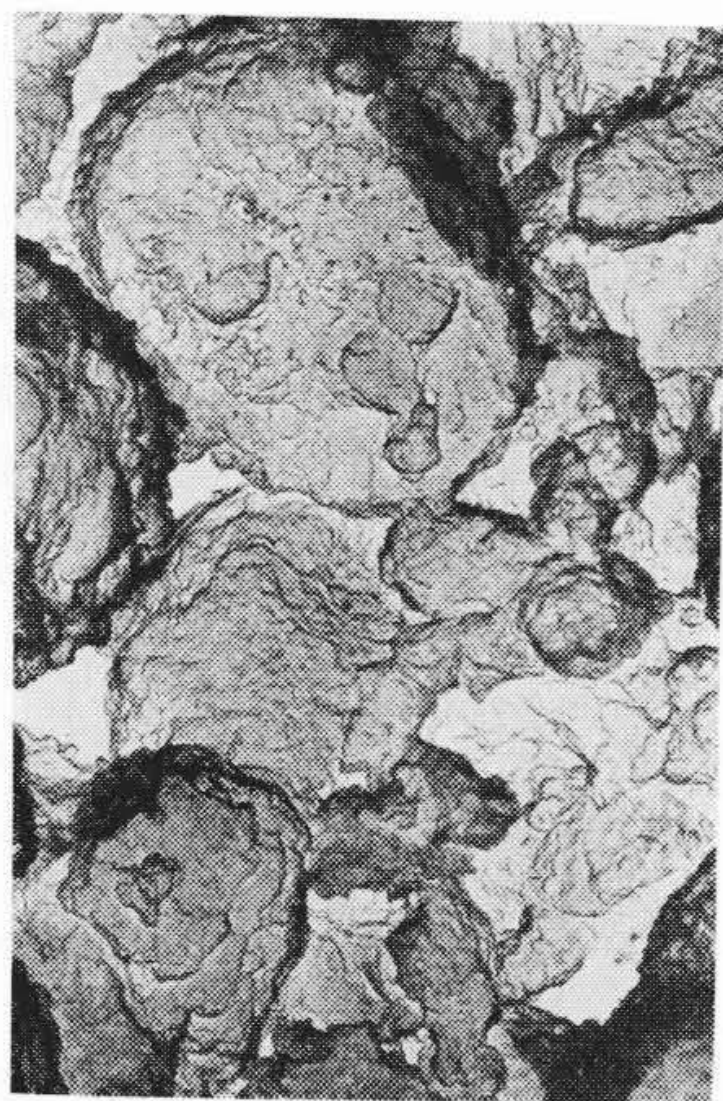
(b) 1,050°C, 4分 加熱後空气中 10' 放置 ( \times 10,000 )
