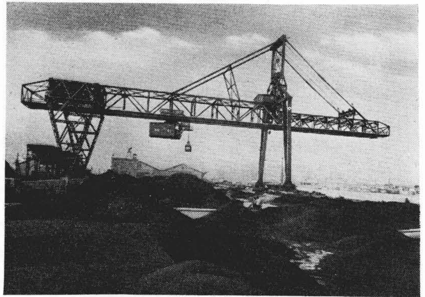
第7図 11t 旋回マントロリ式橋形クレーン
