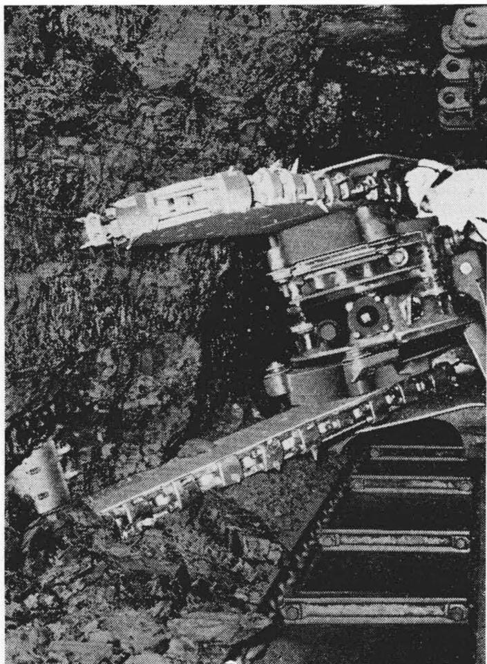
第2図 コールカッタと平形ダブルチェーンコンベヤ
