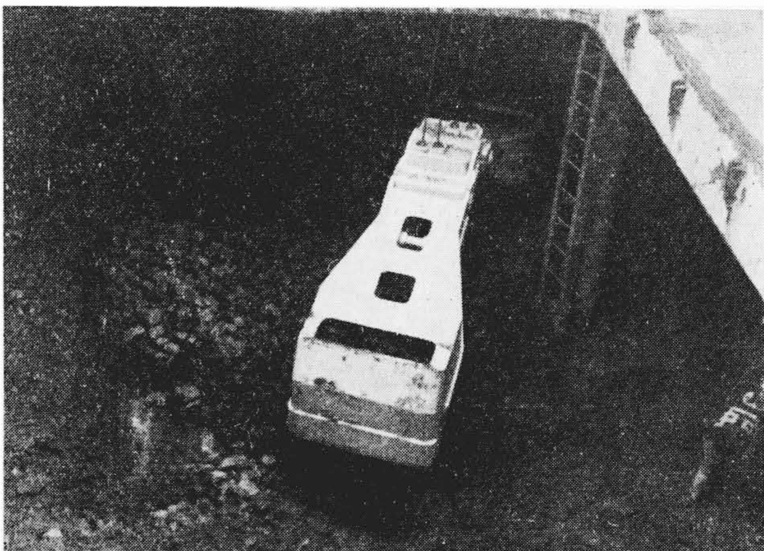
第17図 ハッチ内で荷役中のトリムバケット
