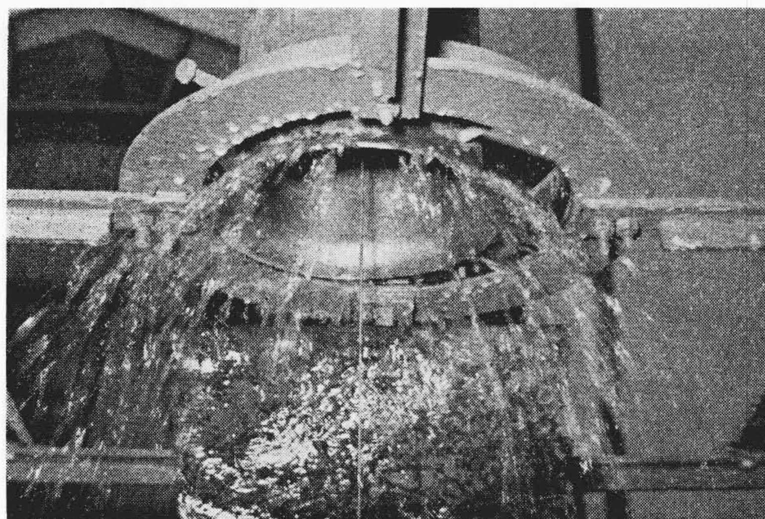
(A) 旧方式電極パイプ
