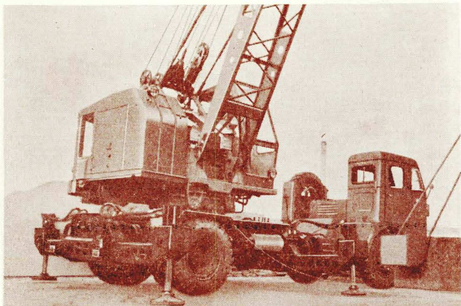
第5図 トラッククレーン用油圧操作式アウトリガー
