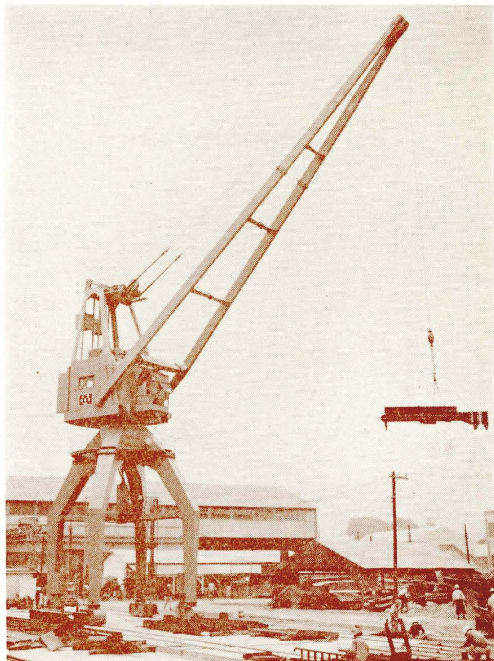
第4図 完成した 5 t 埠頭クレーン
