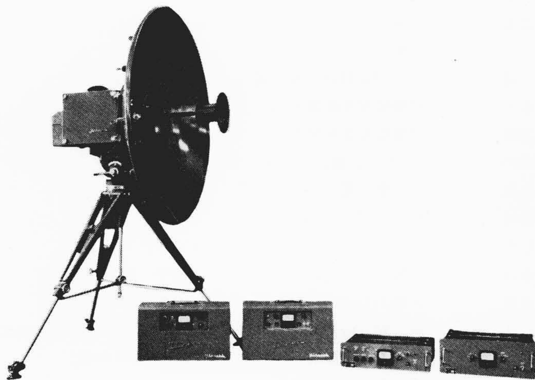
(左より受信高周波部, 主受信機, 受信機電源, 受信制御部, 同期信号盤)
