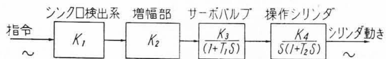
第 24 図 本サーボ系のブロック線図
