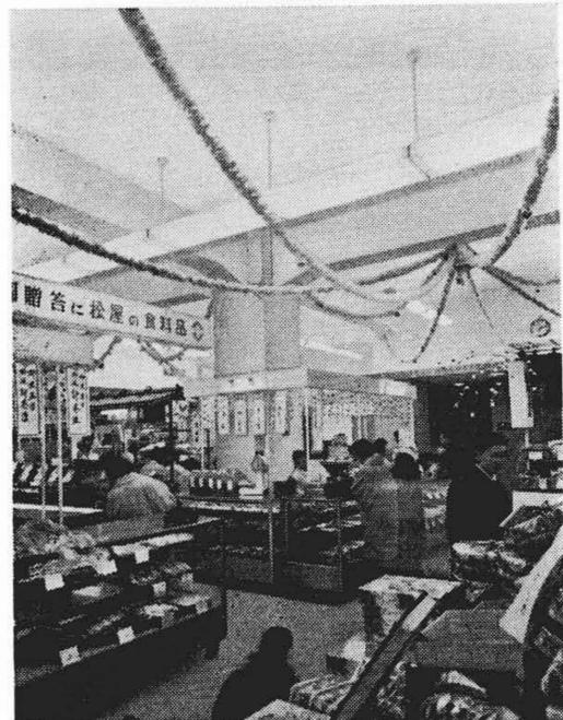
第 9 図 露出形パイプつり下灯具を長く取付けた照明手法
