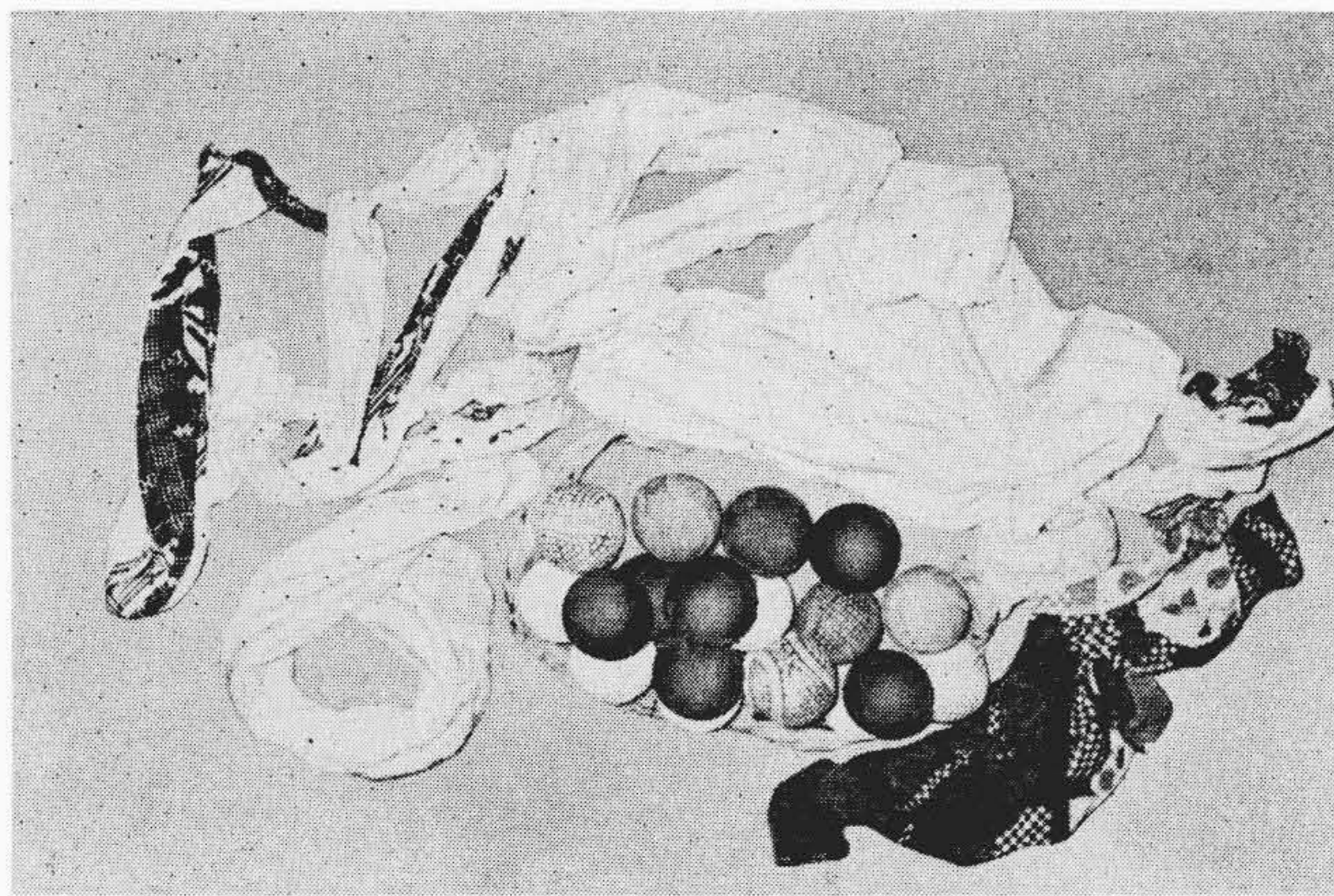
第 14 図 ブレードレスポンプによる取扱固形物
