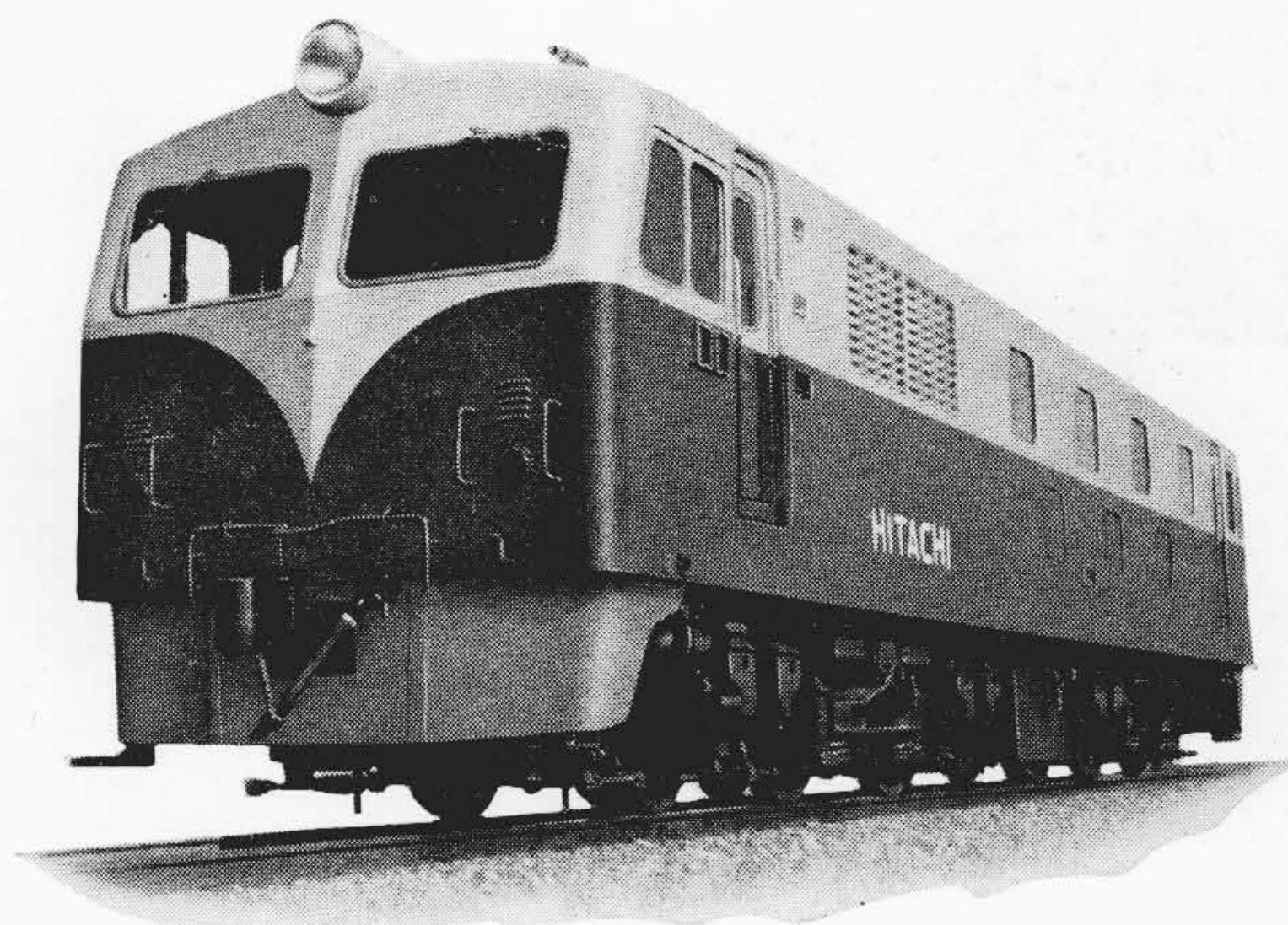
第 5 図 日立 HG-70CC 1,100 PS 液体式ディーゼル機関車
