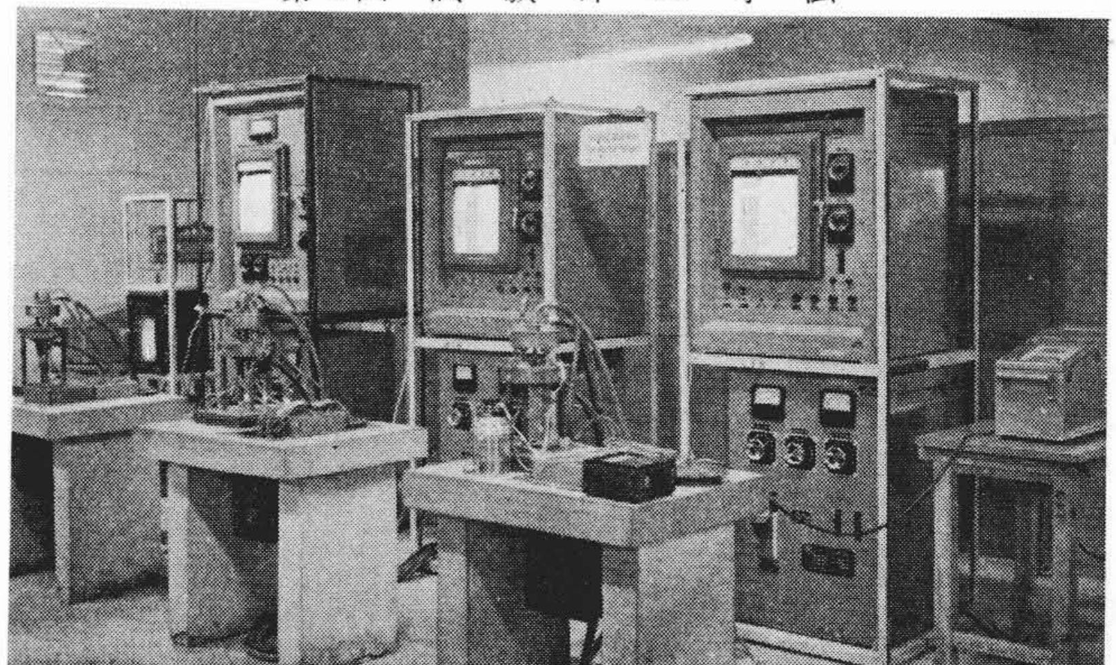
第3図 熱疲労試験機の外観
