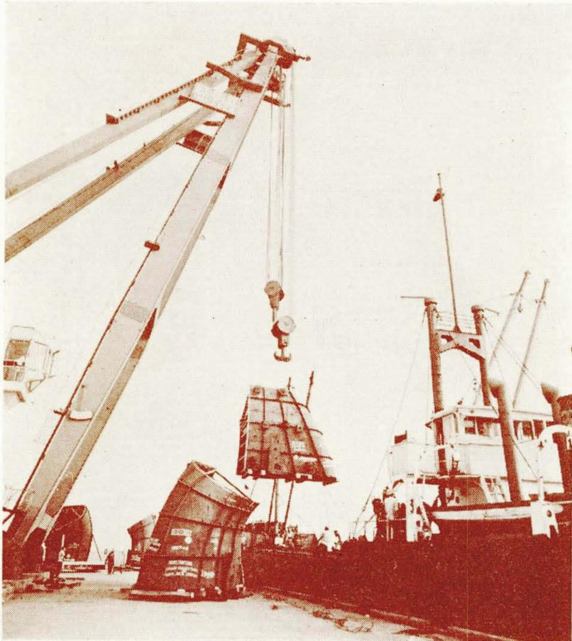
第1図 日立港におけるクリヤクリーク発電所納ドラフトチューブライナの船積
