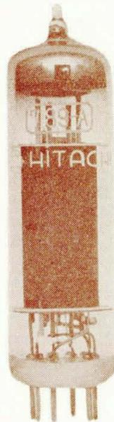
第12図 低周波電力増幅用5極管 7189-A
