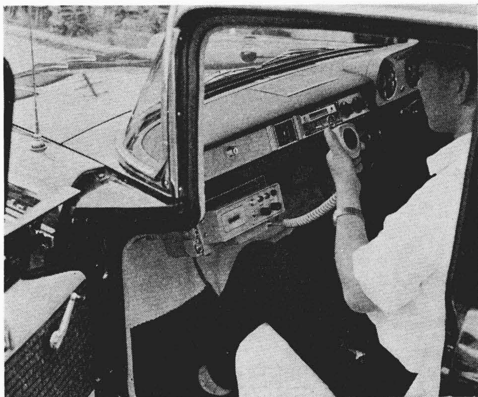
第7図 SEM-055A, SEM-1011A 形 150 Mc 5/10W FM 無線機の自動車取付状況 (その1)
