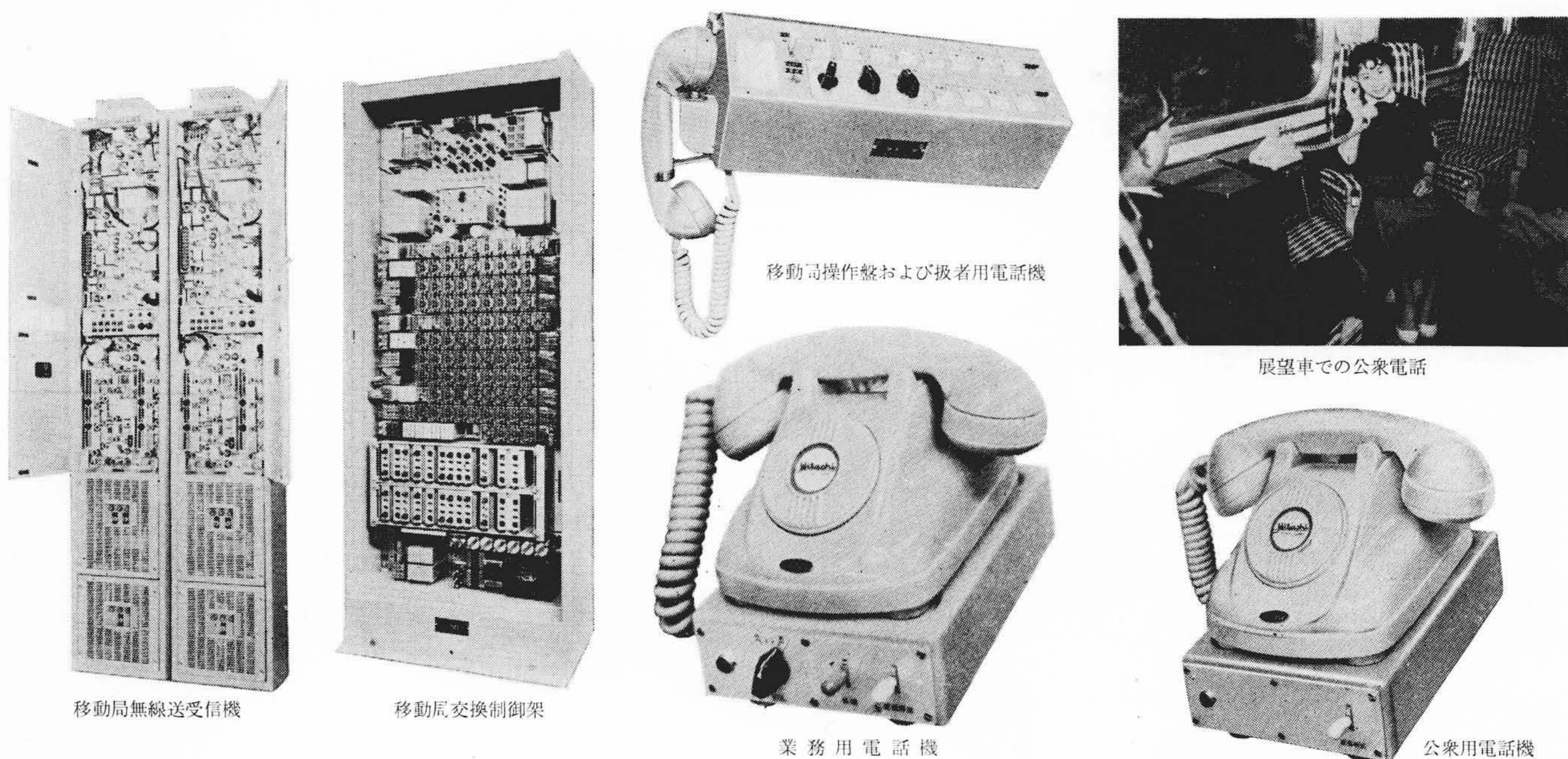
第5図 列車無線車上設備および使用状況図
