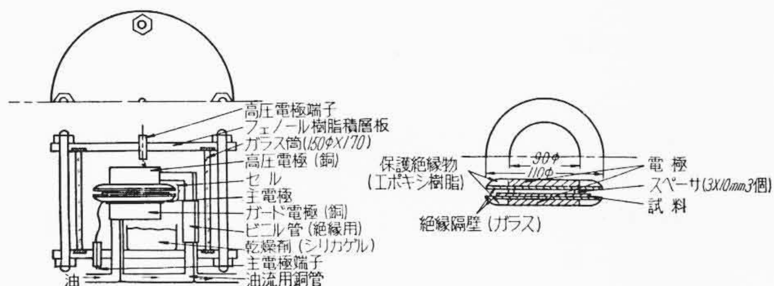
第4図 コロナ劣化試験装置
