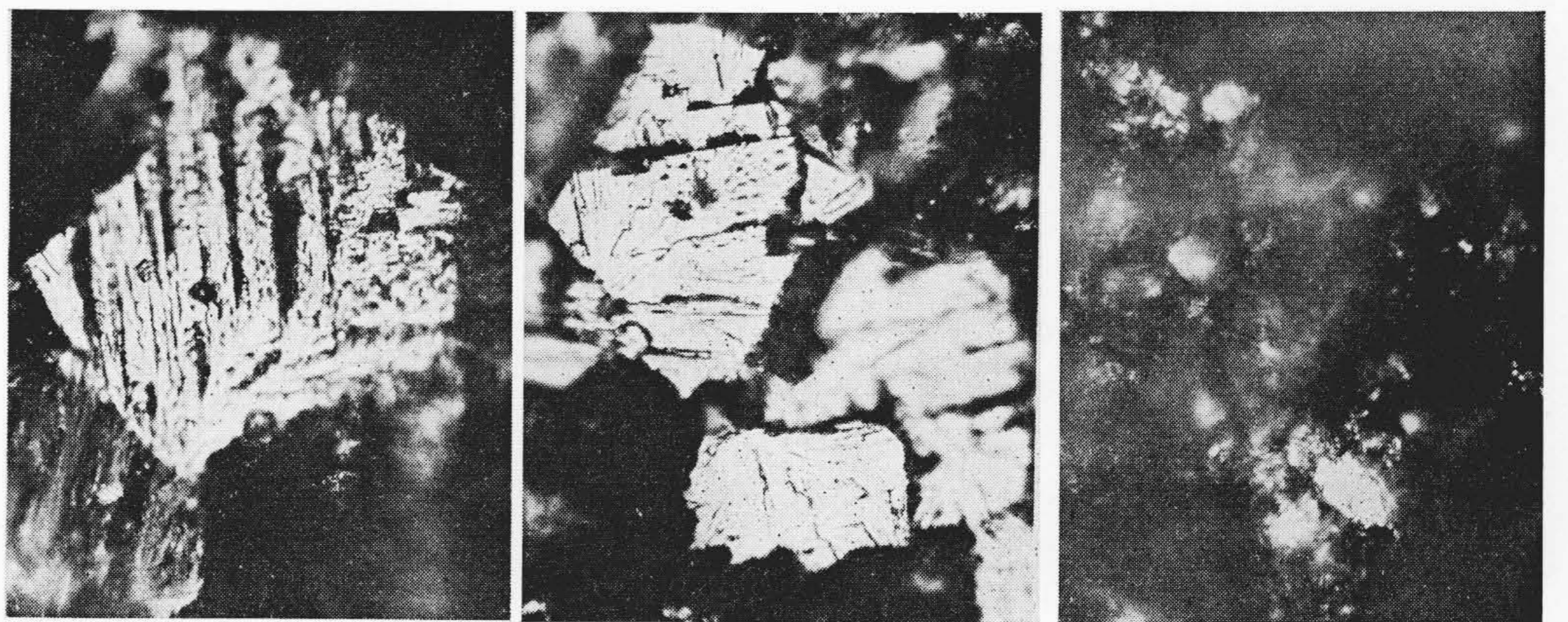
試験温度 (a) -196°C (b) -196°C (c) 50°C 吸収エネルギー 0.54kg-m 0.54kg-m 5.19kg-m 破断の様式 へき開 へき開 すべり
