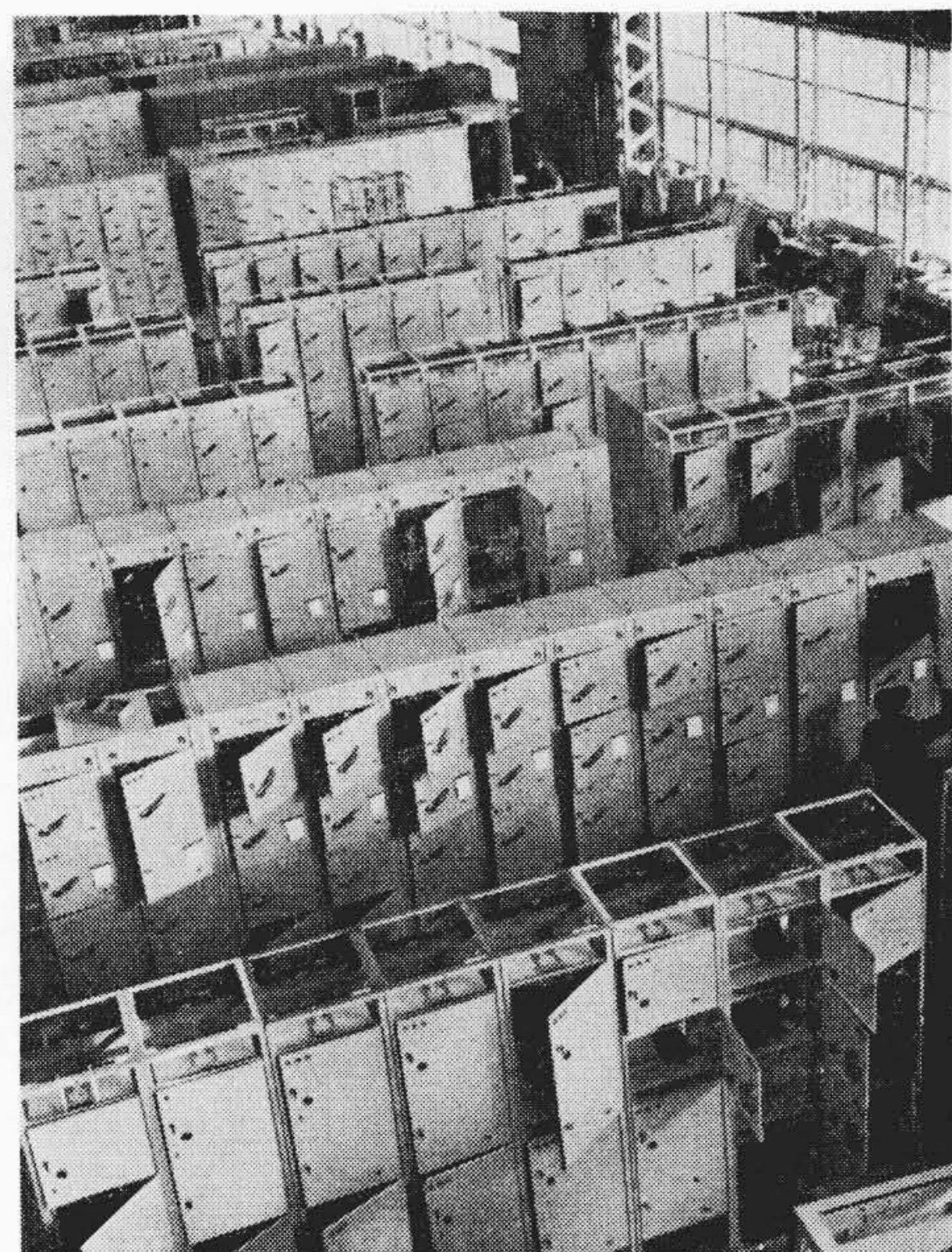
第 41 図 多量生産中のコントロールセンタ
