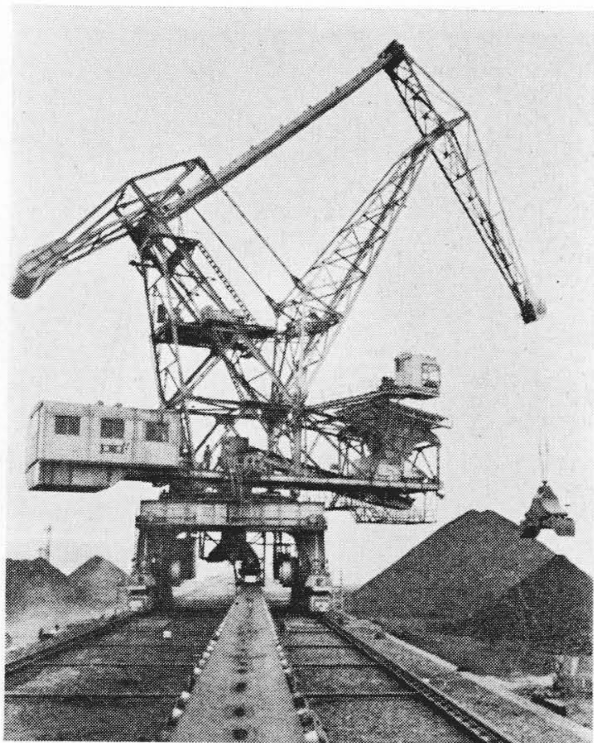
第 15 図 富士製鉄株式会社室蘭製鉄所納 300 t/h 引込クレーン
