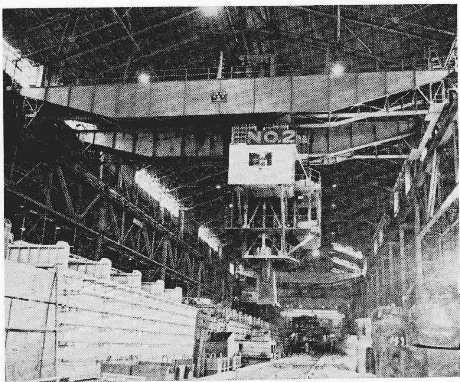
第 13 図 富士製鉄株式会社広畑製鉄所納 23 t ソーキングピットクレーン
