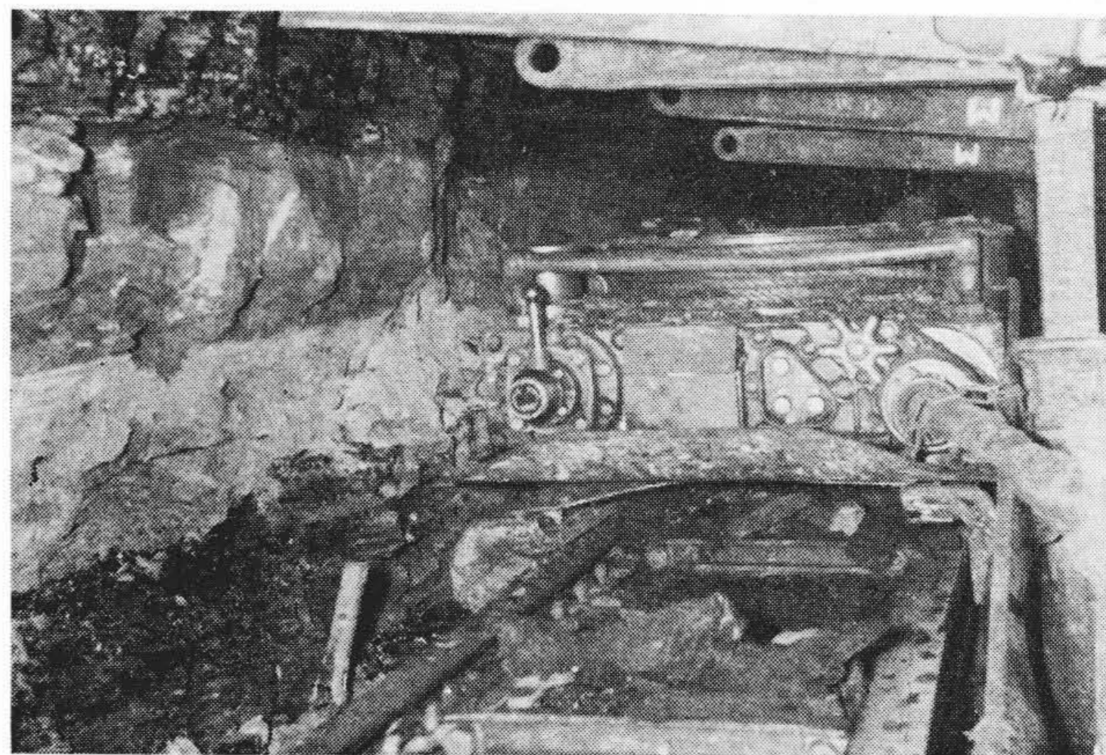
第 4 図 稼働中の薄層 45 kW コールカッタ
