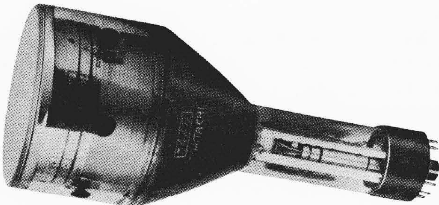
第 1 図 日立直視形蓄積管 7448 の外観
