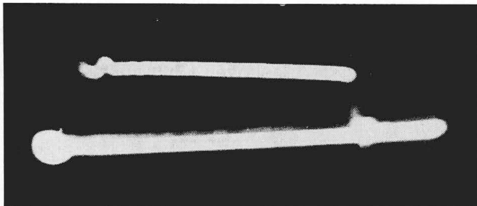
(b) 波尾長 22.4 \mu s E=325 kV \tau=12.1 \mu s (オシロ No. 1228)
