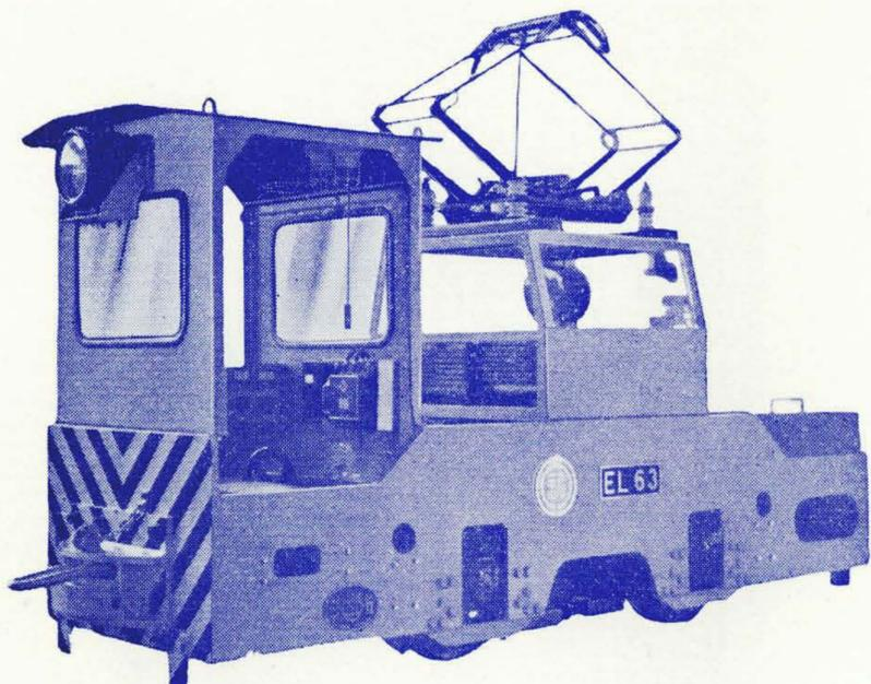
第6図 直流式6t積電気機関車
