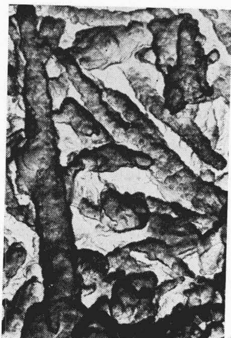
第17図 温度40°C, 湿度85%の条件で24時間放置したMgO塗布マイカ使用マウントの陰極を約930°Cで分解加熱した球の寿命試験完了後の陰極端部の電顕像(12AX4-GTA)(×6,500)
