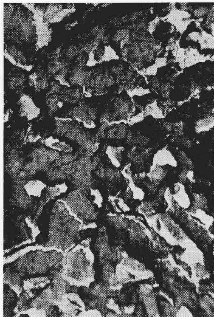
第16図 温度40°C, 湿度100%の条件で15時間放置したMgO塗布マイカ使用マウントを 10^{-2} mmHgの低真空下で I_f=1.8 A, 5分間加熱した場合の陰極端部(1,020°C)の電顕像(×6,500)
