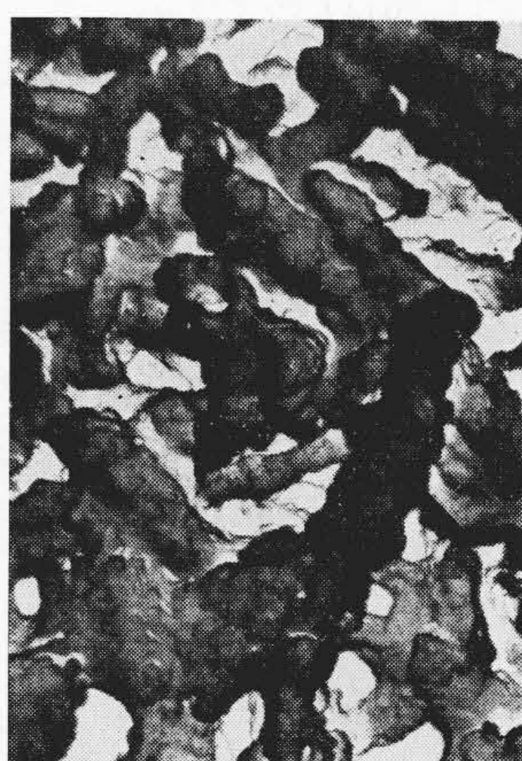
第18図 温度40°C, 湿度85%の条件で24時間放置したMgO塗布マイカ使用マウントの陰極を約1,100°Cで分解加熱した球の寿命試験完了後の陰極端部の電顕像(12AX4-GTA)(×6,500)
