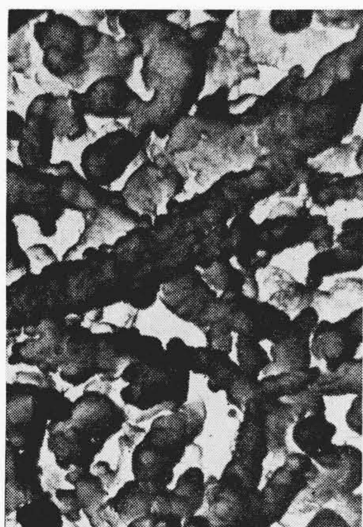
第17図 温度40°C, 湿度85%の条件で24時間放置したMgO塗布マイカ使用マウントの陰極を約930°Cで分解加熱した球の寿命試験完了後の陰極端部の電顕像(12AX4-GTA)(×6,500)
