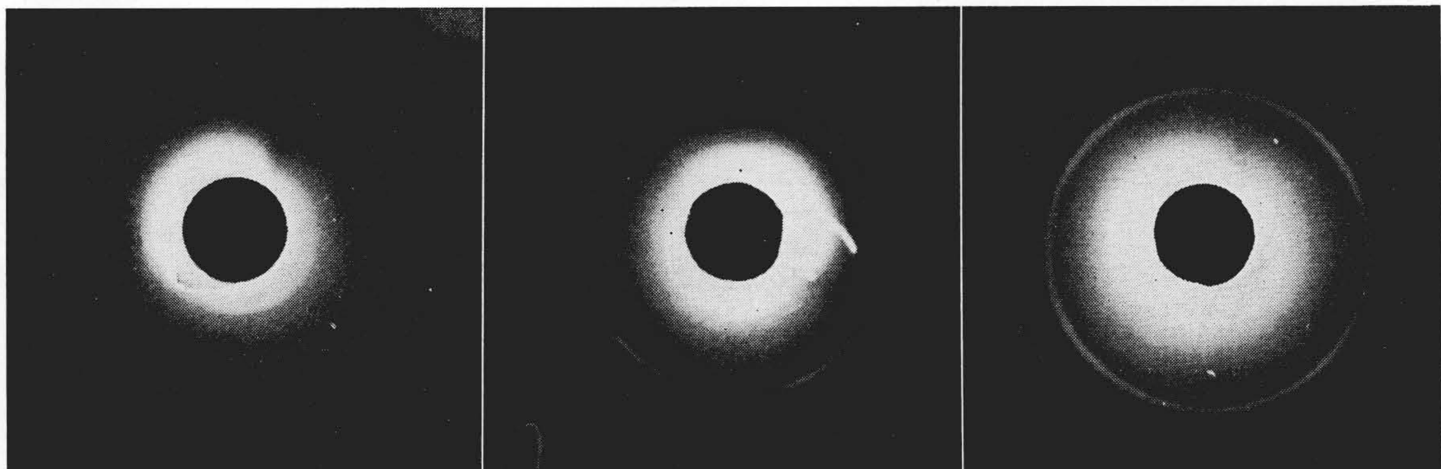
第9図 試番2の最終加工材のX線回折写真
