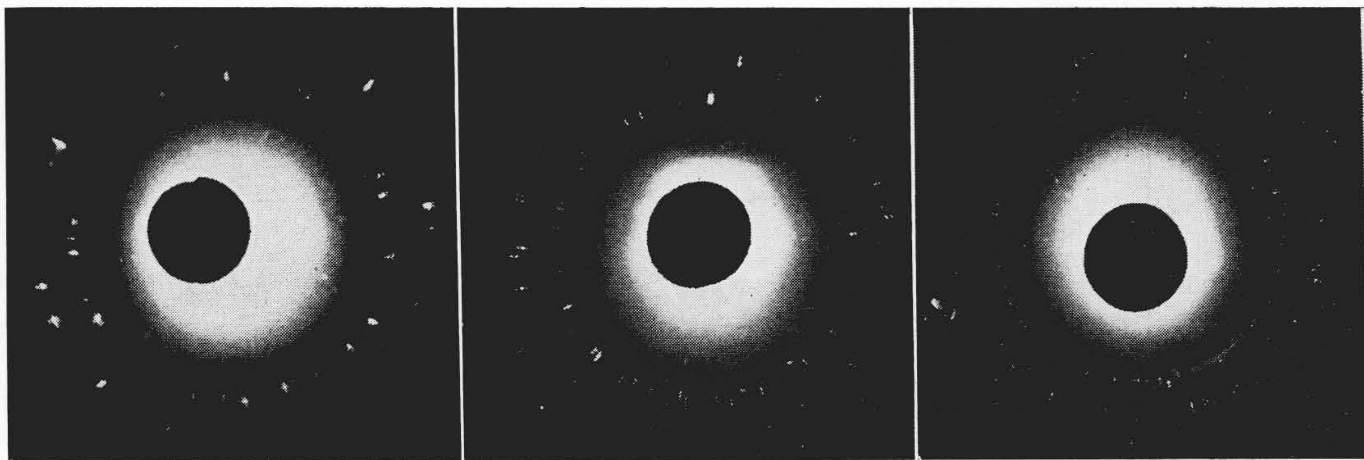
第8図 試番1の最終加工材のX線回折写真
