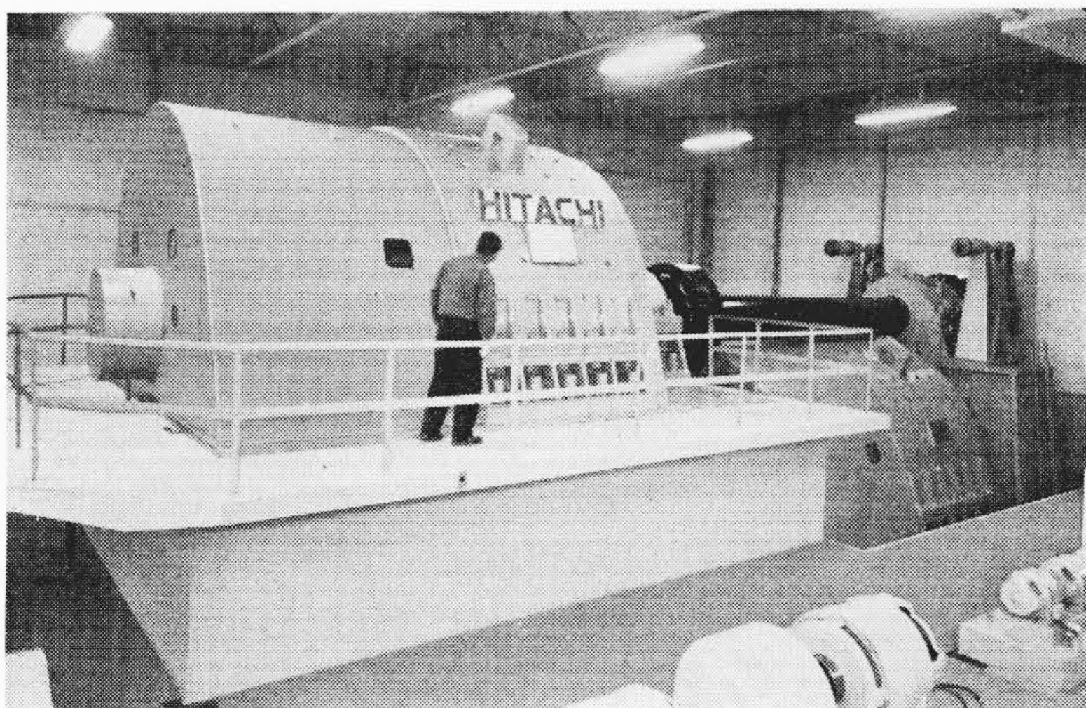
第3図 分塊圧延機用 7,500 kW 主直流電動機 ±40/80 rpm, ±750 V (双駆動方式)
