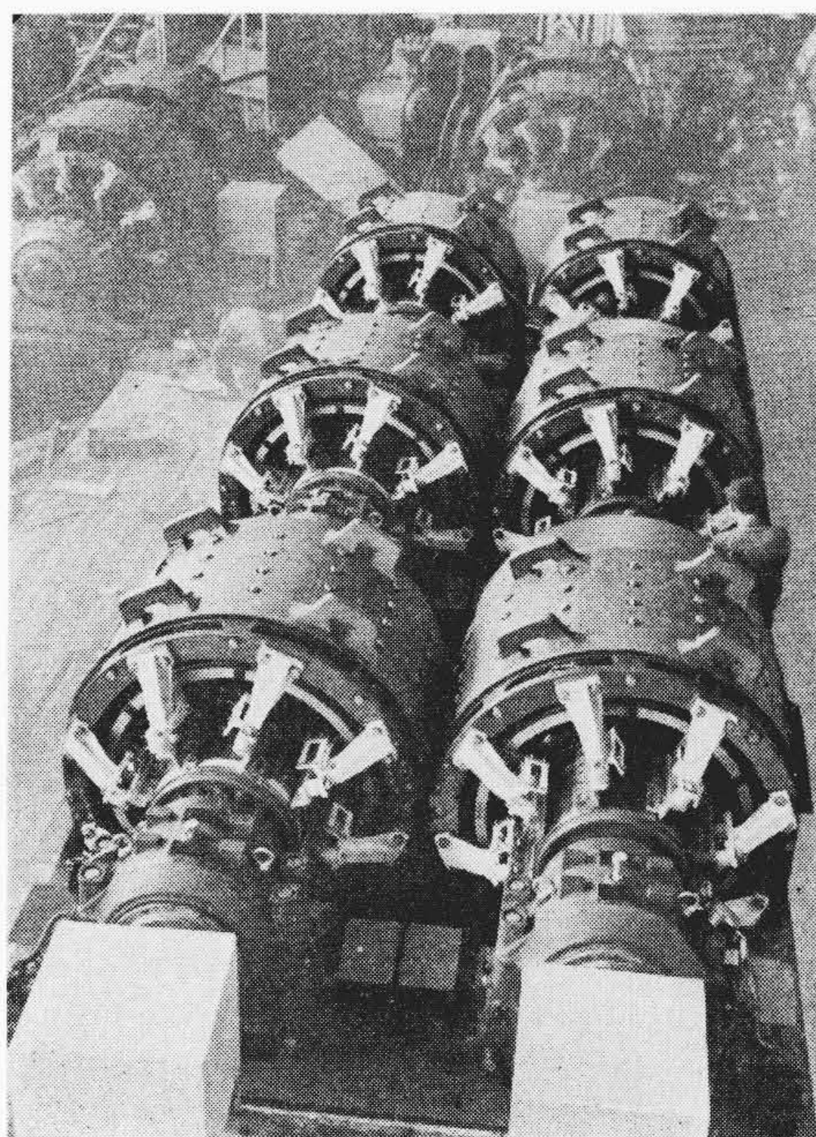
第13図 タンデムコールド圧延機 第6スタンド駆動用 2 \times (3 \times 950 \text{ kW}) 直流電動機 300/635 rpm 600 V (双電動機駆動)
