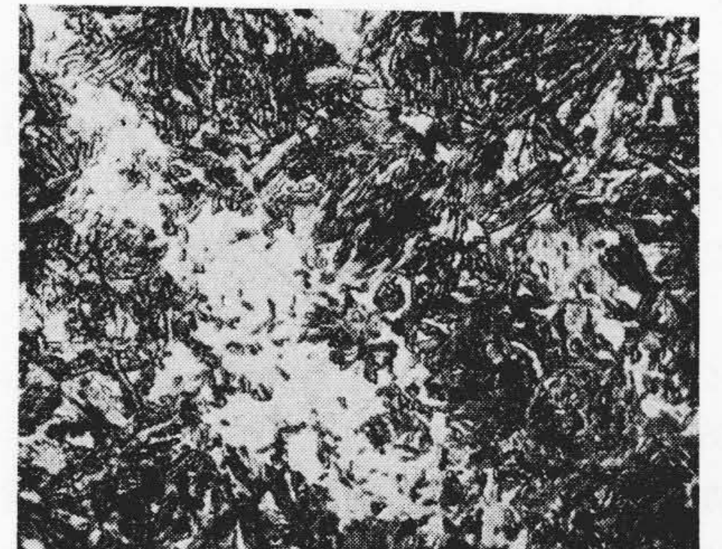
第11図 350℃にて6時間恒温処理したものの組織 (×420)
