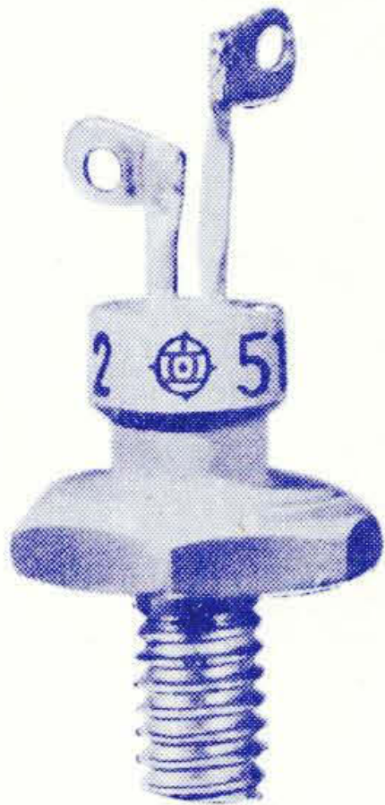
第 24 図 ZCSU 12 形 (順電流 3 A) シリコン制御整流素子
