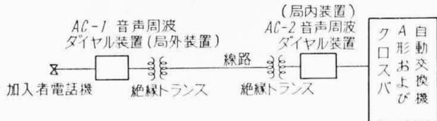
第10図 音声周波ダイヤル装置中継方式図
