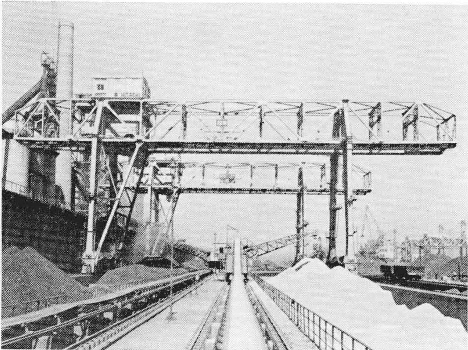
第8図 八幡製鉄株式会社納 500 t/h 橋形クレーン
