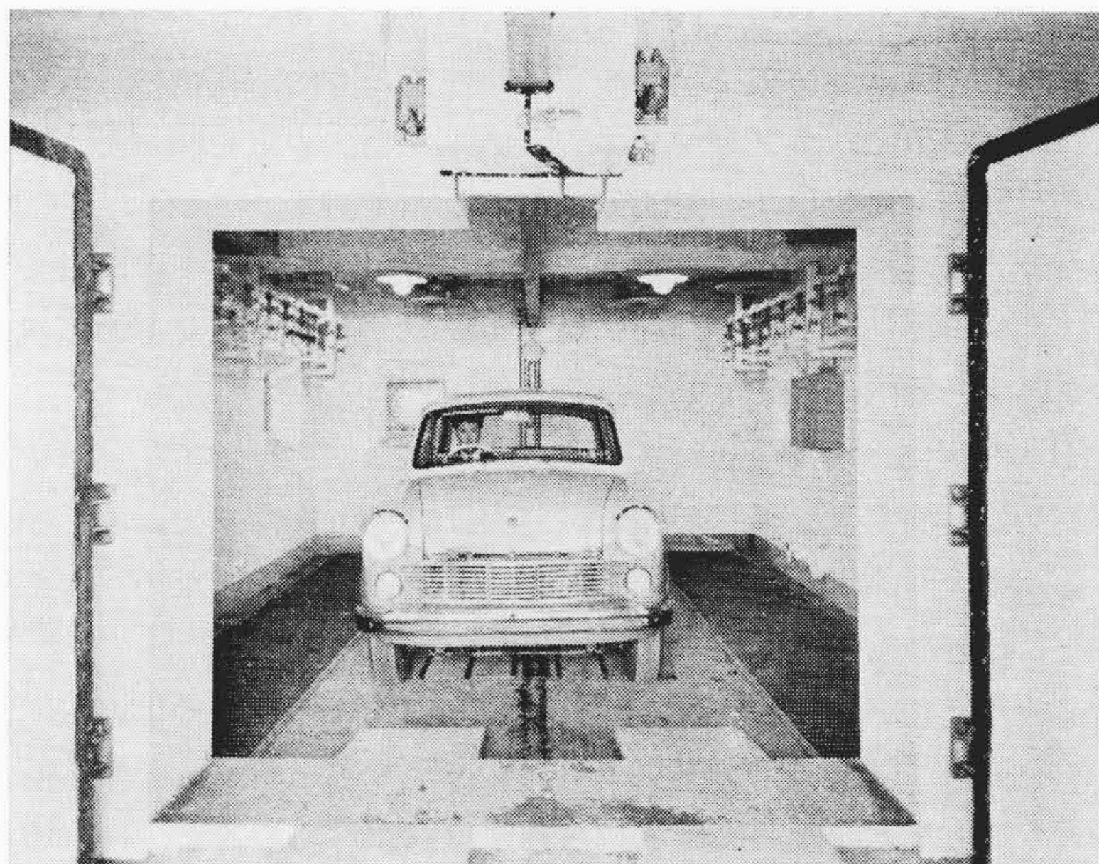
第30図 日産自動車株式会社(追浜工場)納エンジン試験用環境試験装置
