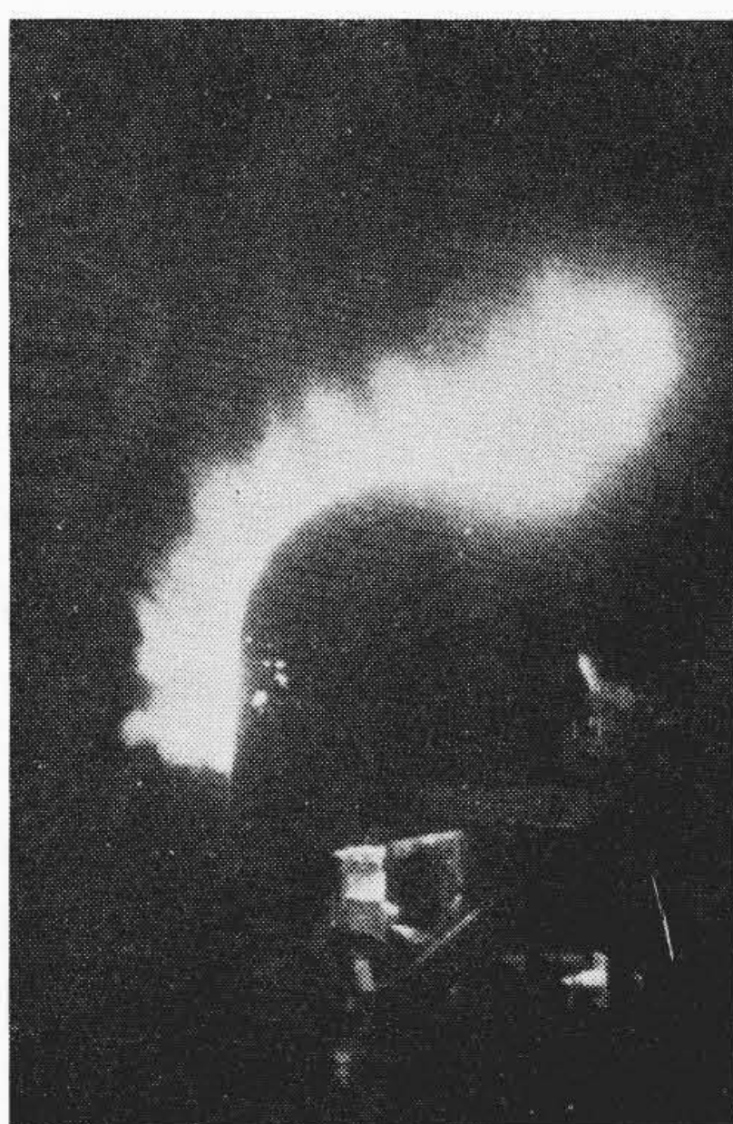
第9図 三相 7.2 kV 4,500 A 遮断状況
