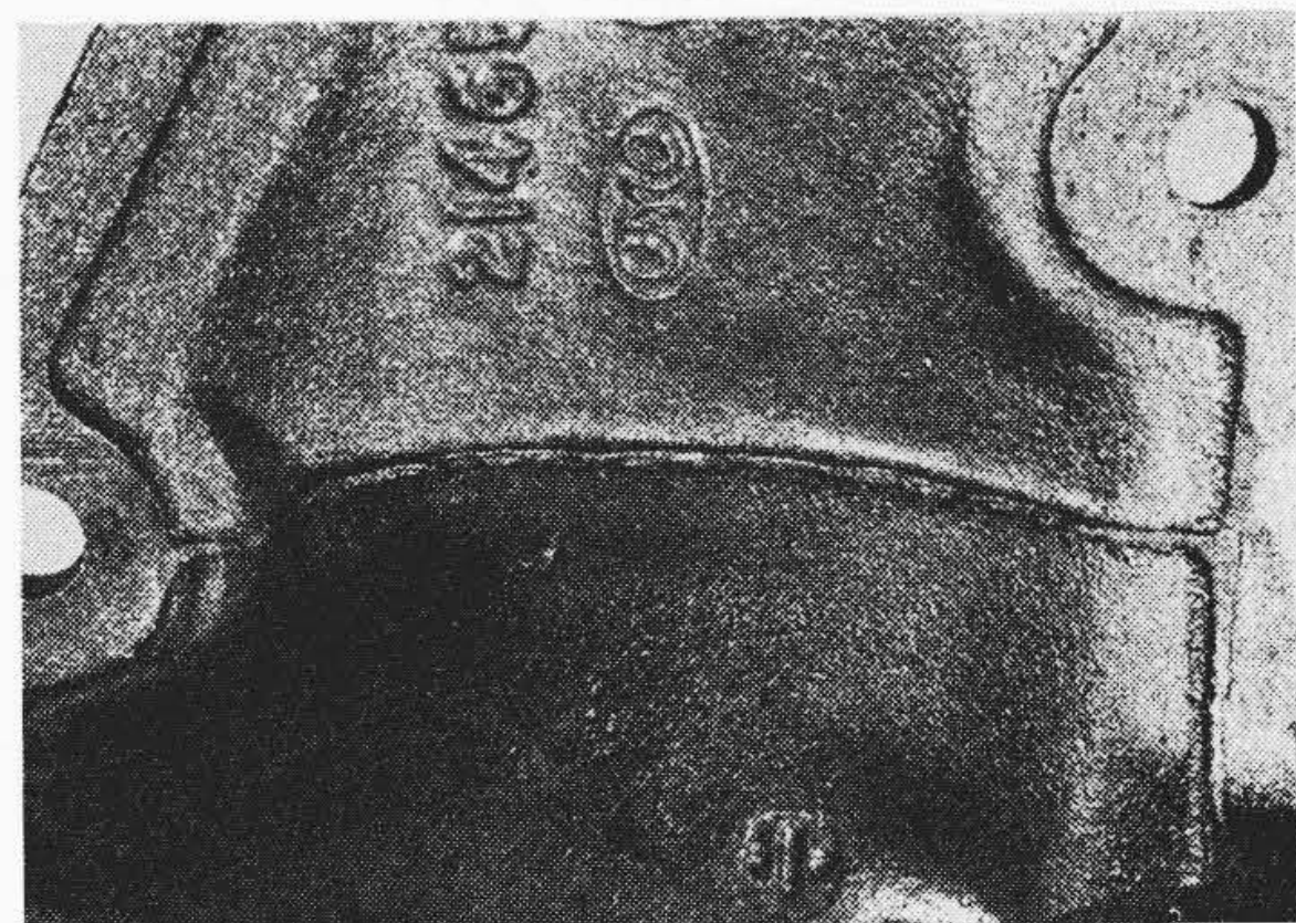
第20図 スプリングブラケットの裏面の鋳バリ
