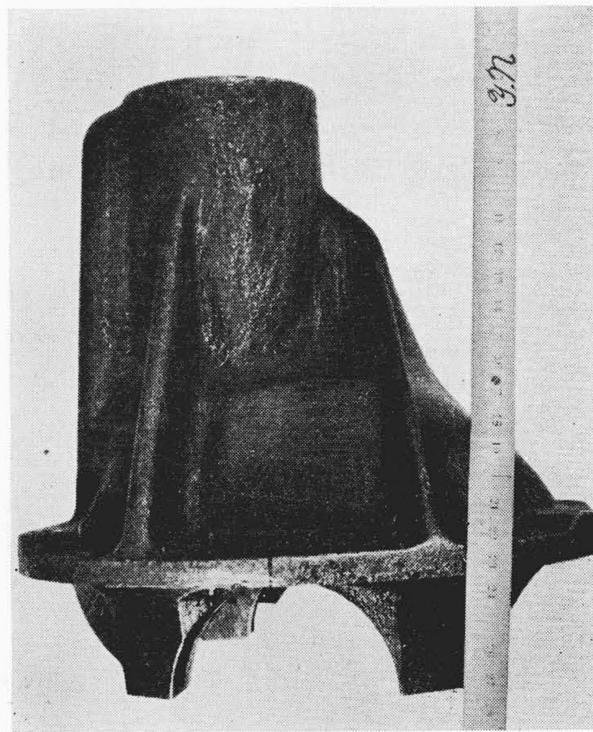
第10図 湯口部分のリブが厚くなっている
