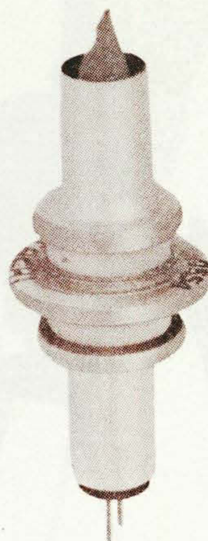
第24図 セラミックペンシル形高増幅率3極管“7554”
