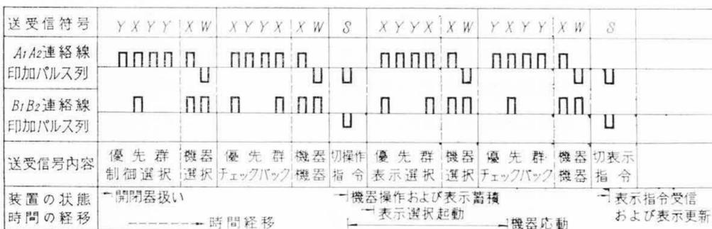
第7図(a) 制御所よりの制御およびその応動表示の場合のパルス送受例
