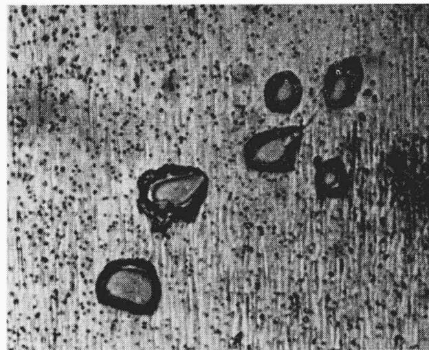
第13図 Si-Pb-Cu合金スライダ材の顕微鏡組織(×720)
