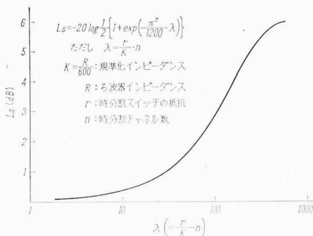
第7図 時分割スイッチ損失  $L_s$  の変化
