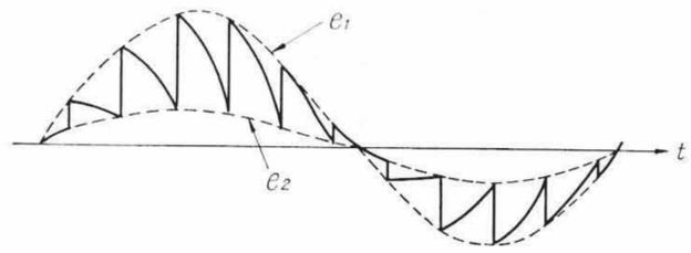
第 9 図 受信側ろ波器の入力端子の電圧波形
