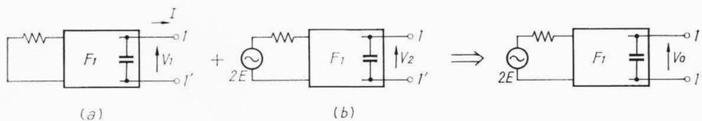
第8図 送信側ろ波器の出力電圧の重畳
