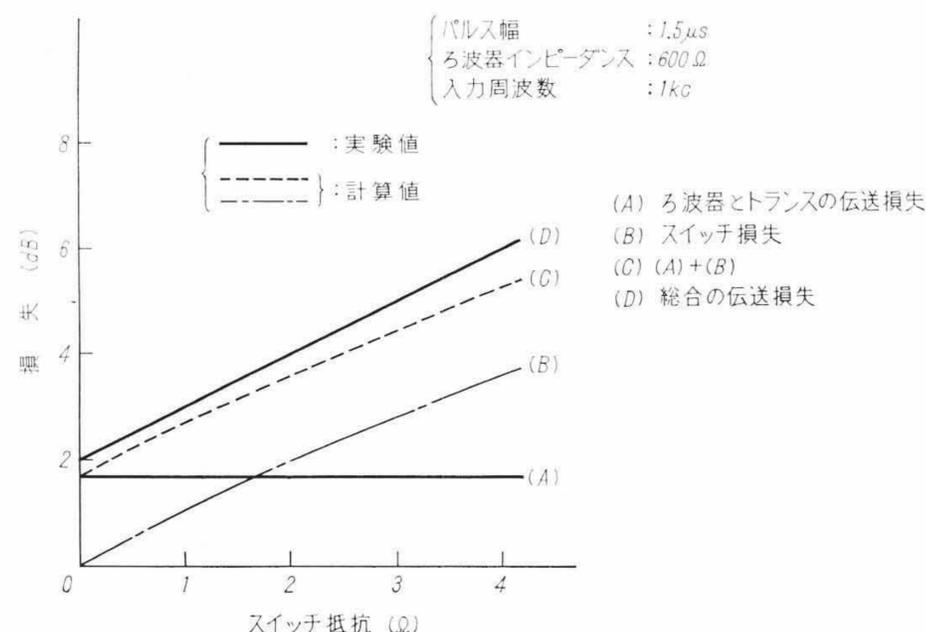
第 6 図 スイッチ抵抗による伝送損失 (実験値と計算値の比較)
