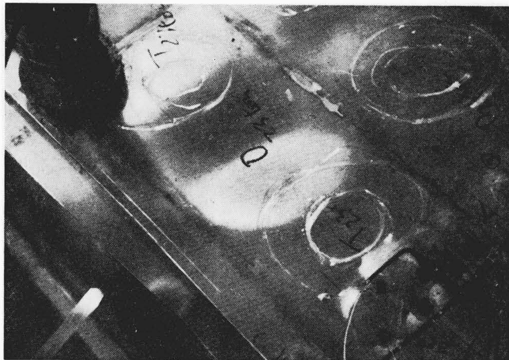
第23図 モデル No. 1 の座屈状況
