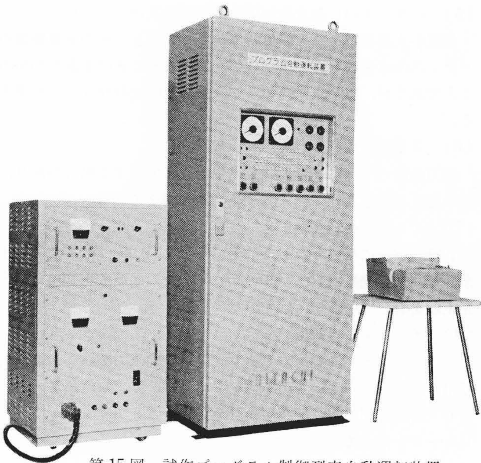
第 15 図 試作プログラム制御列車自動運転装置
