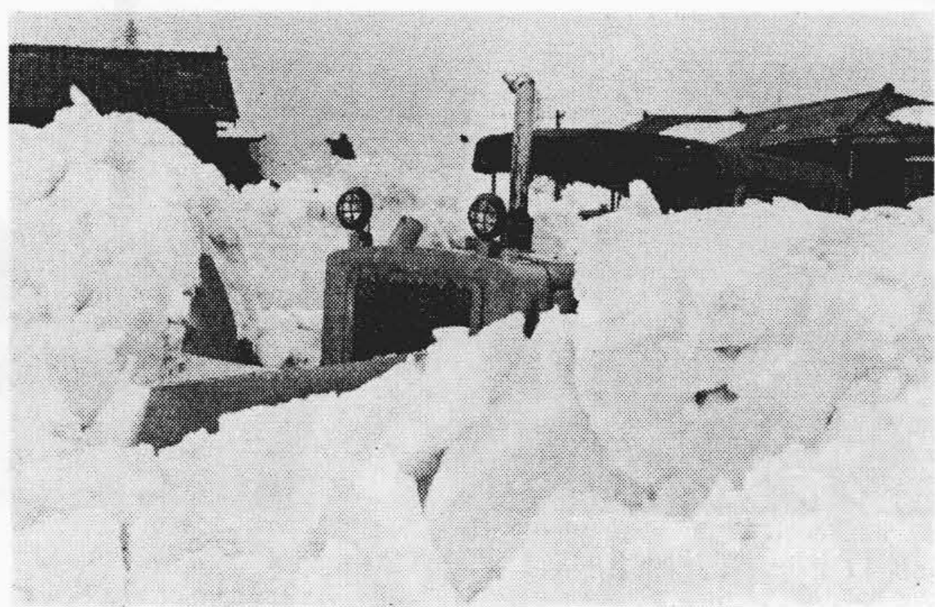
第12図 除雪作業中のスノウブラウ付 T09
